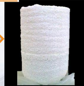
Поликристаллический блок  $Al_2O_3$
